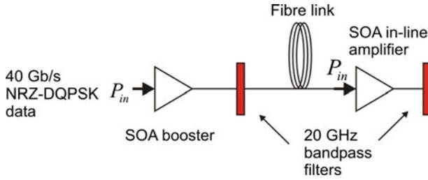
**Fig. 1** 40 Gb/s NRZ DQ-PSK link
